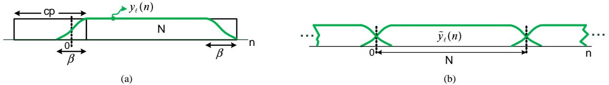
Figura 5. Método de *windowing* en el receptor. (a) Conformación del símbolo OFDM recibido. (b) Solapamiento temporal del símbolo OFDM antes de calcular la DFT.
